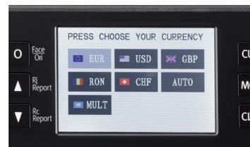
Die Währungsauswahl erfolgt über das hochwertige TFT-Farbdisplay mit Touchscreen-Oberfläche. Auch das Zählen von gemischten Banknotenstapeln mit unterschiedlichen Währungen ist möglich.
