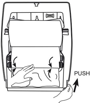
Knicken Sie ein Stück des Papier ein und schieben diese (doppelte) Lage zwischen die beiden Transportrollen. Dann drehen Sie rechts am Transportrad, bis das Papier unten aus dem Spender kommt.
