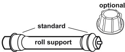
Die Achsen werden mit Standard-Adaptoren für einen Kern-Ø von 38mm geliefert.
